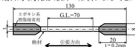
図 2.1 引張試験片の形状および寸法 (mm)
